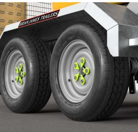
○ Indicateurs de desserrage des vis de roues
